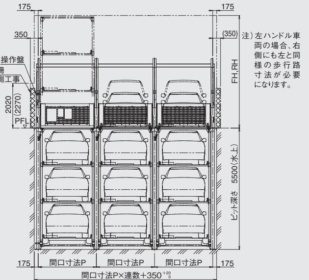
注) 本装置は出庫動作完了後、地下階が下降した状態が定位位置です。
