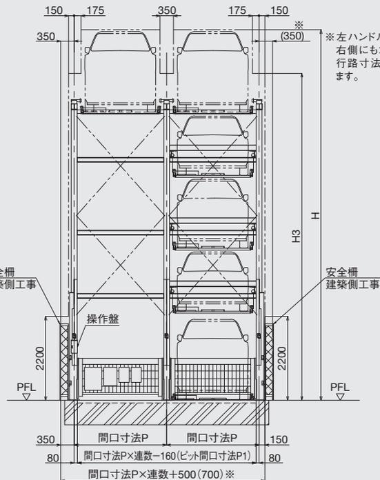
注1) 本図は各パレットの定位置状態を示し、通常の状態では昇降するパレットのいずれかが乗込み位置にあります。
